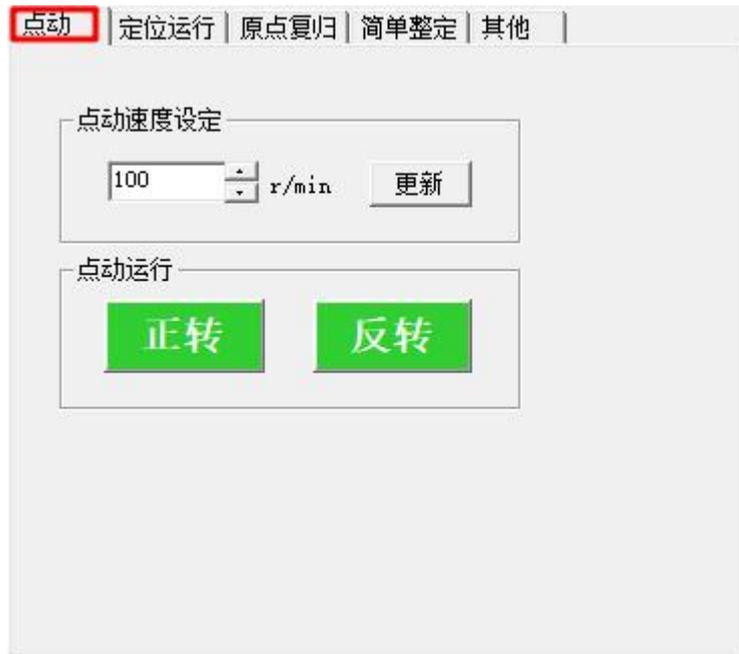
在点动选项卡中，可以修改点动的速度，同时可以执行点动正转和点动反转。
