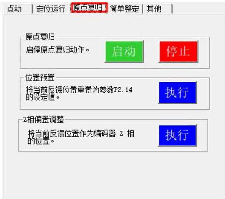
在原点复归选项卡中，可以启动原点复归的动作，还可以执行位置预置及 Z 相偏置调整。
