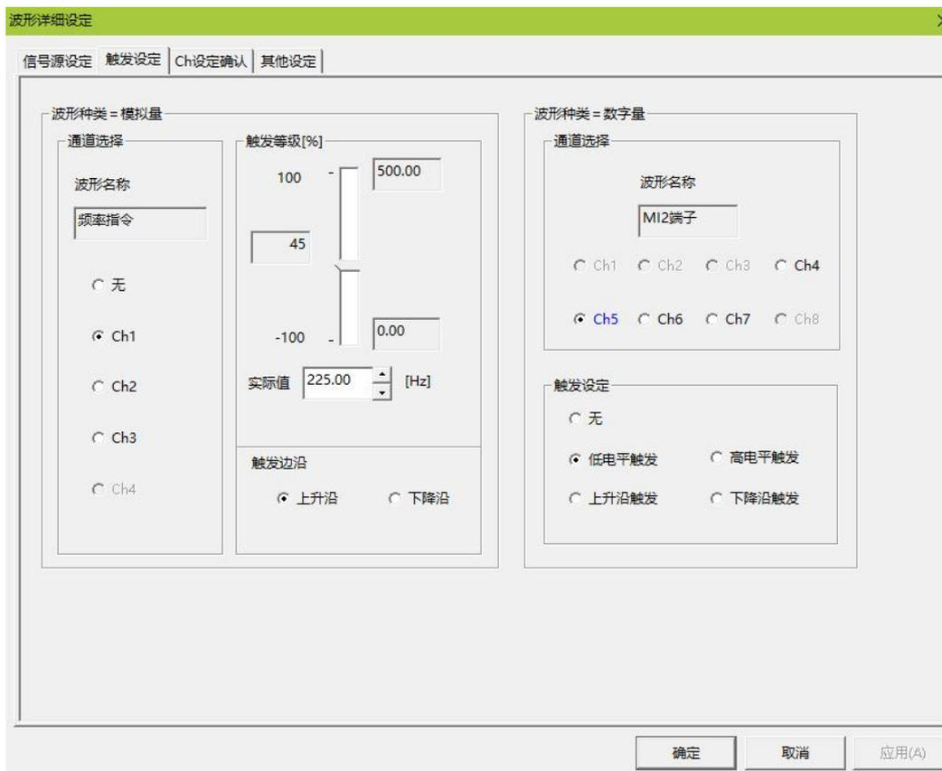
模拟量触发只可以设定一个，选中要作为触发条件的模拟量通道之后，可以设定该通道的触发等级以及触发边
