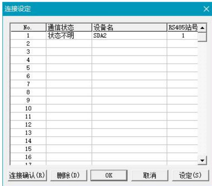
在连接设定中，添加几个设备就表示要连接几台伺服，添加伺服可以通过双击表格或者单击右下角的“设定”按钮，打开详细设定对话框，在详细设定对话框中设定伺服的设备名称和站号。
