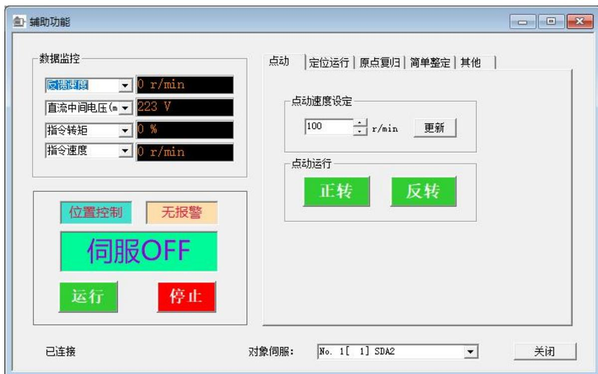
左边包括【数据监控】和伺服状态及运行和停止的控制，在【数据监控】中共有 4 组监控数据可供选择。右边共有 5 个选项卡，包含点动、定位运行、原点复归、简单整定和其他五个功能。
