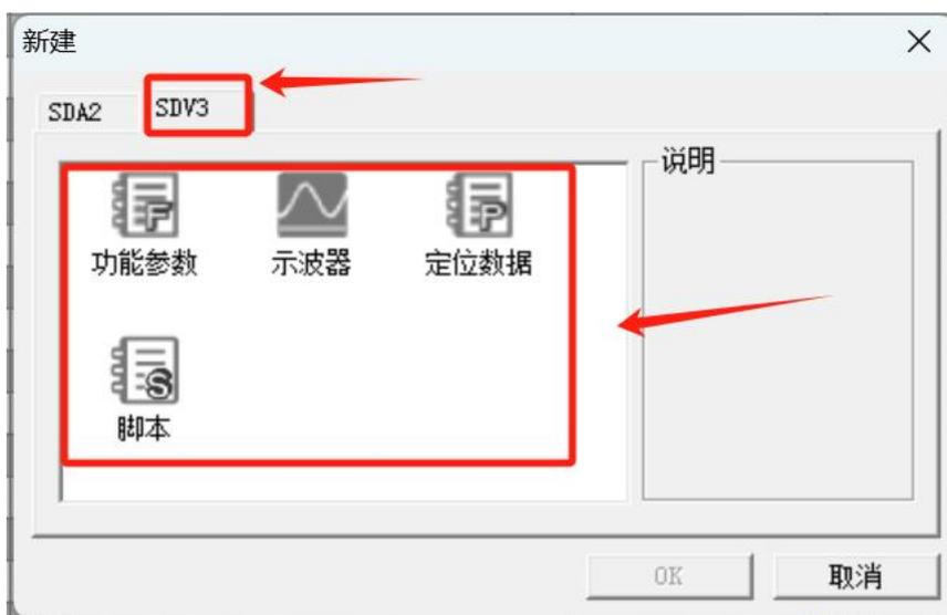
新建功能参数数据文件时，作为一览表可以打开软件默认的功能参数数据。因此即使在伺服和计算机未连接的状态下，也可以进行功能参数数据的编辑。
