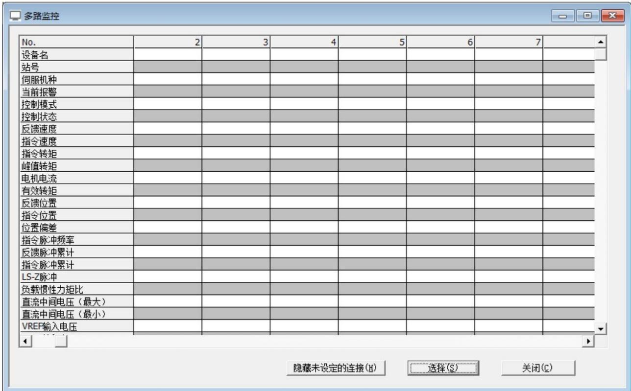
单击“选择”按钮，打开显示项目的选择对话框（如下图），可以对所需显示项目进行增减，在需要显示的项目前打勾，不需要的去掉打勾状态，最后按 OK 即可。
