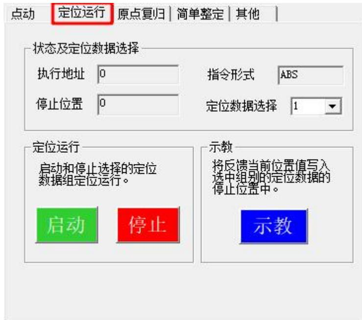
在定位数据选项卡中，可以选择要启动的定位数据组别，还可以通过【示教】按钮，将伺服当前的反馈位置写入当前选择的定位数据组中。
